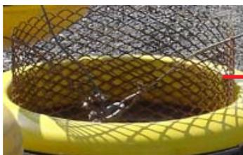
5 - Fixer la crépine d'entrée sur les trois tétons soudés sur la trémie inox
