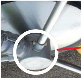
3 - Fixer les jambes des flotteurs sur la plate-forme de refoulement avec les boulons Ø 12 X 70 mm
